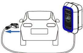
步驟2. 從電動車的充電端口拔出充電槍。
